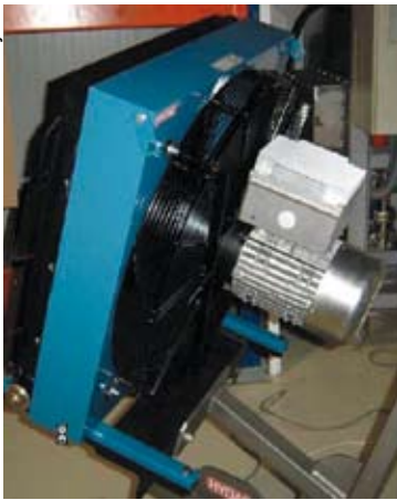
Grâce aux nouvelles technologies d'entraînement du ventilateur à vitesse variable, l'utilisateur peut réduire sa consommation de carburant.
